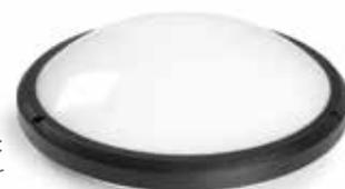
Un boîtier rond en polycarbonate auto-extinguible V2, blanc ou noir de 2 mm d'épaisseur. Le boîtier est pourvu d'une entrée câble dans le dos. Un cadre de la même matière que le boîtier dans lequel vient se positionner le diffuseur. Ce cadre est fixé au boîtier par 3 vis en inox. Une petite lampe led est fixée à l'intérieur pour la présence tension.
